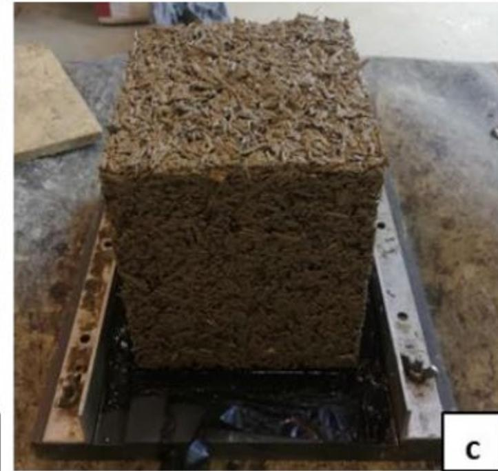
Fabricación por capas con vibro-compactado
